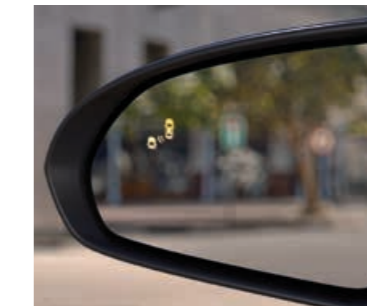
Sistema di monitoraggio degli angoli ciechi (BSD) avverte della presenza di veicoli non visibili nell'angolo cieco attraverso segnali visivi e acustici.
