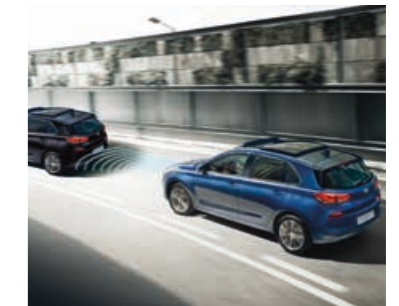
Advanced Smart Cruise Control (ASCC) mantiene una distanza di sicurezza pre-impostata dal veicolo che precede, aumentando o riducendo automaticamente la velocità se necessario.
