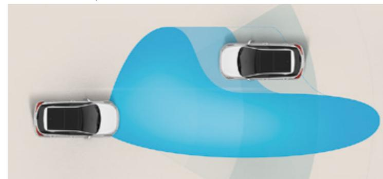
**High Beam Assist (HBA)** Il sistema di gestione automatica degli abbaglianti (HBA) individua i veicoli che provengono in senso contrario, così come quelli che precedono, e passa automaticamente dai fari abbaglianti agli anabbaglianti migliorando la sicurezza e la visibilità notturna.
