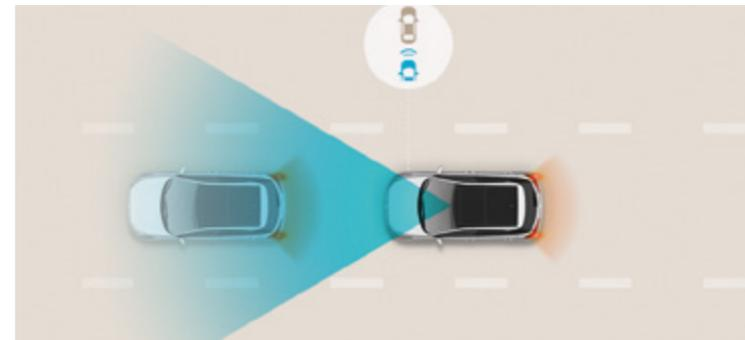
**Forward Collision-avoidance Assist (FCA)** Monitorando la strada di fronte a te, attraverso una telecamera, il sistema FCA frena in automatico ogni volta che rileva una frenata improvvisa dell'auto che ti precede. Inizialmente ti allerta visivamente e acusticamente, in seguito adegua la potenza di frenata al livello di pericolo e applica la massima potenza frenante per evitare la collisione. Il sistema si attiva a partire dalla velocità di 10 km/h.
