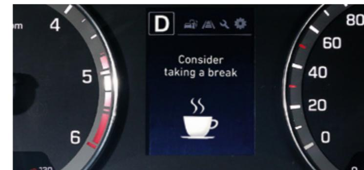
**Driver Attention Warning (DAW)** Il dispositivo DAW accresce la sicurezza monitorando e analizzando costantemente lo stile di guida. Quando identifica segnali di stanchezza o di fatica il DAW attira l'attenzione del conducente con un segnale acustico e un messaggio visivo che suggerisce di prendersi una pausa.
