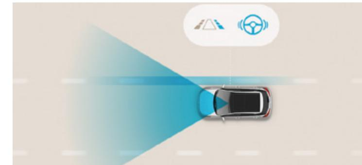
**Lane Keeping Assist (LKA)** Il sistema LKA allerta il conducente in caso di spostamenti pericolosi a partire dalla velocità di 60 km/h, monitorando la posizione della vettura. Un allarme acustico e visivo precede la correzione dello sterzo per riportare il guidatore in una posizione sicura.
